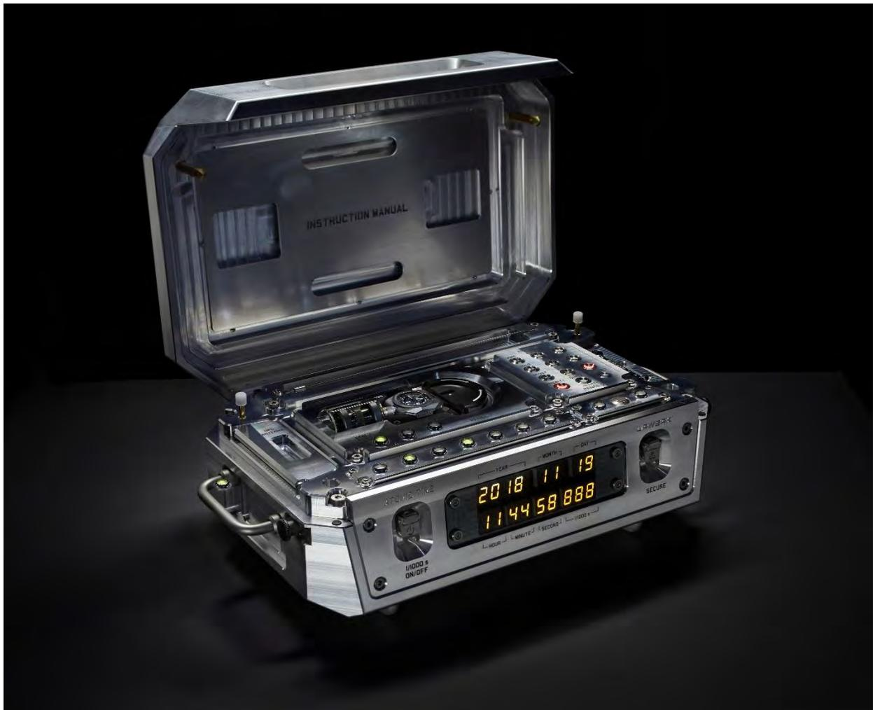
ウルベルクのAMCプロジェクトは、連結する2つの自律システムから構成されるハイブリッド時間測定装置です。最初の部分はAtomolithe/アトモライトという固定ベースで、重量約35キログラムの原子時計が、平均的なコンピュータタワーほどの大きさをしたアルミニウム製ケースに収まっています。2つ目の部分は可動要素で、腕に装着するかベースに設置される、完全な機械式腕時計から成ります。
