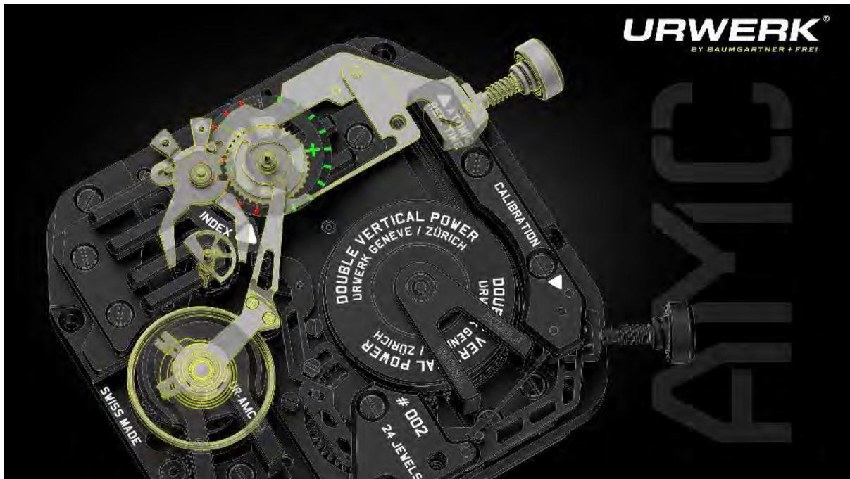
La marche d'une montre mécanique est régie par un régulateur, qui prend généralement la forme d'une raquette contrôlant la longueur réelle du ressort du balancier. Lorsque le propriétaire d'une montre constate que celle-ci avance ou retarde, il la confie à un horloger qui, par un simple déplacement de la raquette, modifie la longueur effective du ressort du balancier. Cette opération a pour effet d'accélérer ou de ralentir la marche de la montre.
