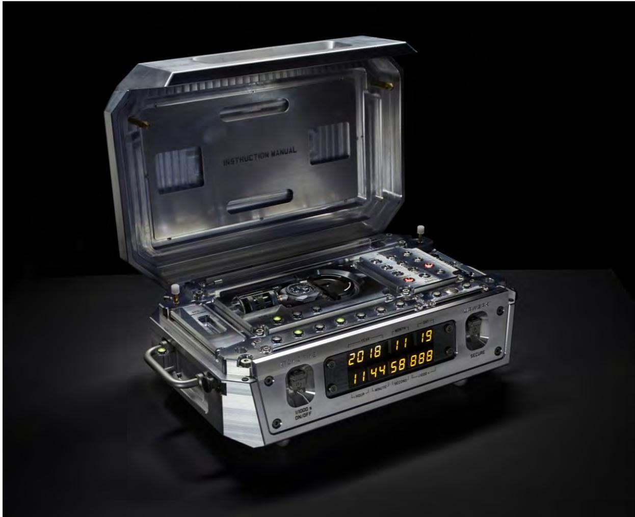
Le projet AMC d'URWERK est un instrument de mesure du temps hybride, composé de deux systèmes autonomes reliés entre eux. La première partie – l'Atomolithe – est une base fixe, constituée d'une pendule atomique de 35 kg logée dans un boîtier en aluminium aux dimensions à peu près similaires à celles d'une tour informatique de taille moyenne. La deuxième partie est un élément mobile, constitué d'une montre purement mécanique pouvant se porter au poignet ou s'arrimer à sa base.
