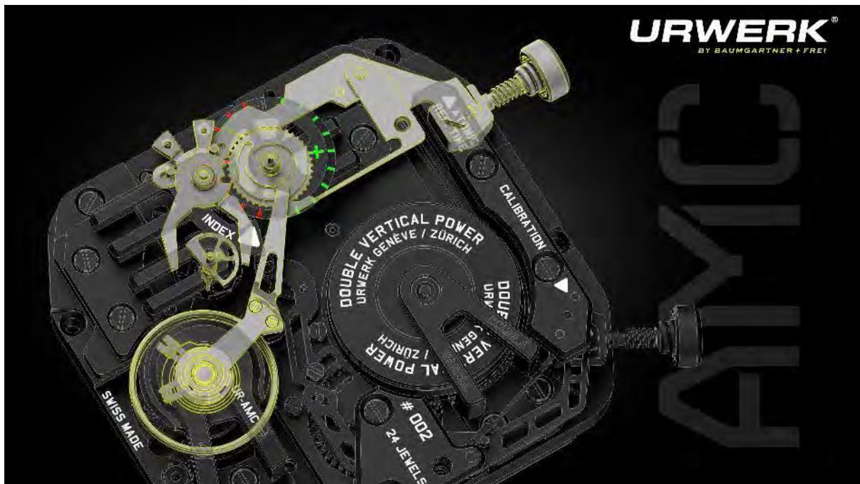
腕錶準確度、即誤差之多寡由微調結構控制，快慢針是常見的微調模式，可以設定游絲有效運作的長度，如腕錶走得過快或過慢，可以微調快慢針調節游絲有效運作的長度，從而加快或減慢擺輪的擺動。
