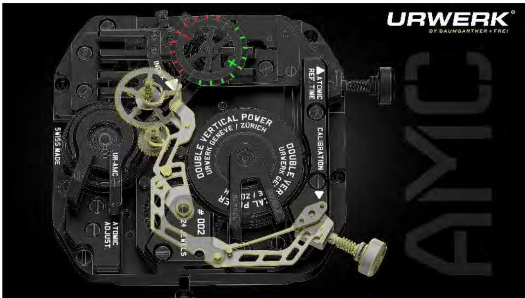
校正腕錶分鐘及秒鐘的原理跟自動誤差微調不同，反而與計時錶的歸零設定相似。校正腕錶分秒的時候，同樣由原子鐘去啟動腕錶的按鍵，按鍵會推動腕錶內兩支槓桿，壓向與分針及秒針連繫的心形凸輪，令凸輪轉動並帶動分針及秒針至歸零為止，這時候腕錶已校正至與原子鐘同步。
