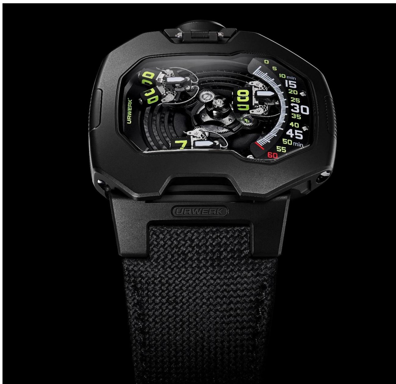
La dernière-née de la constellation URWERK exploite un satellite des heures qui se dédouble. Dans le calibre UR-20.01, le carrousel central est équipé de trois bras supportant chacun un satellite. Chaque face du satellite est porteuse d'un indicateur horaire. Lorsque celui-ci sort du rail des minutes et atteint la partie gauche de la boîte, il actionne un déclencheur qui commande le changement de face. Le satellite dévoile alors sa vraie nature avec une séquence cinématique inédite.
