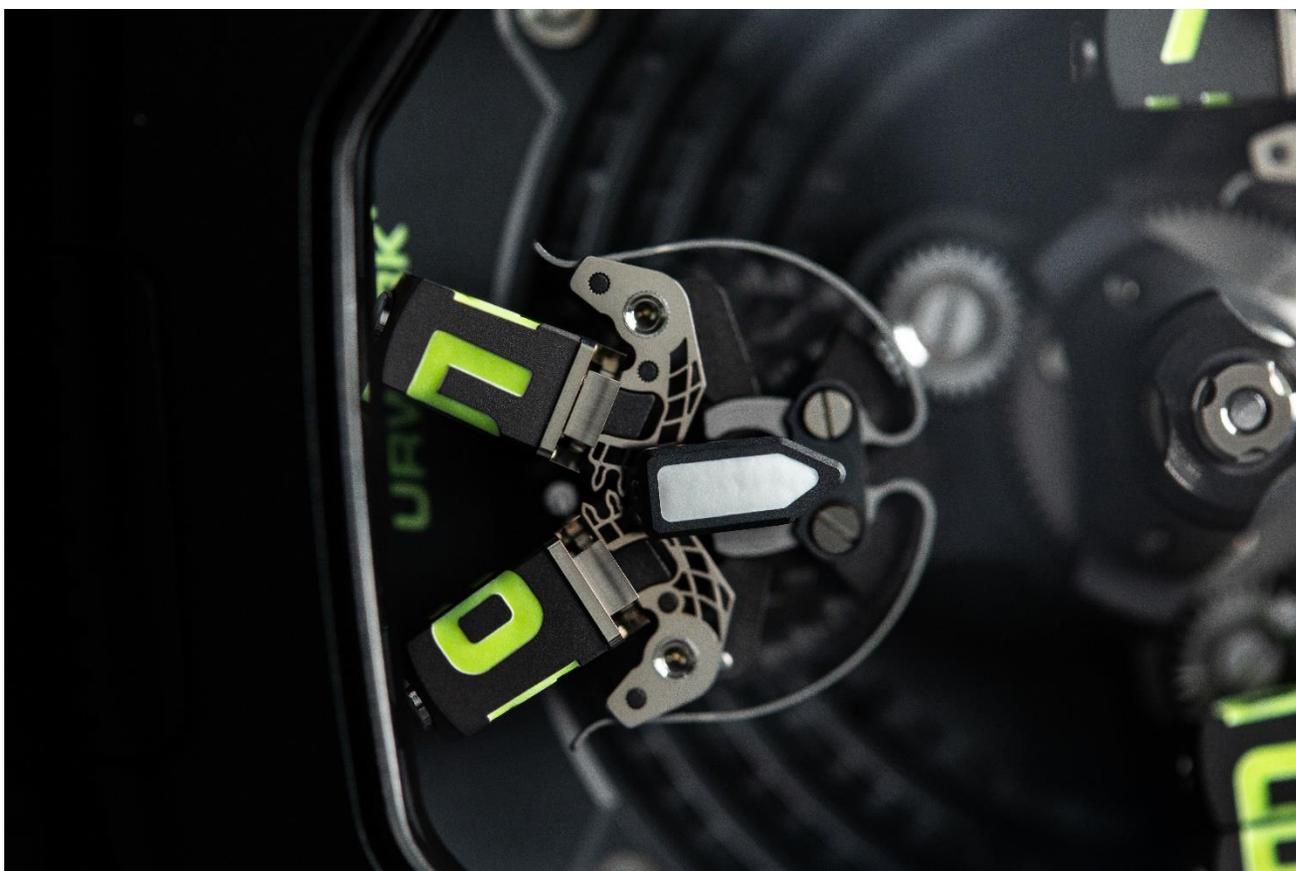
Il se produit une triple révolution sous le capot de ce vaisseau spatial : le carrousel portant les satellites tourne sur un axe central, chaque satellite tourne en sens inverse pour rester droit et donc lisible, et chaque élément tourne sur son propre axe.
