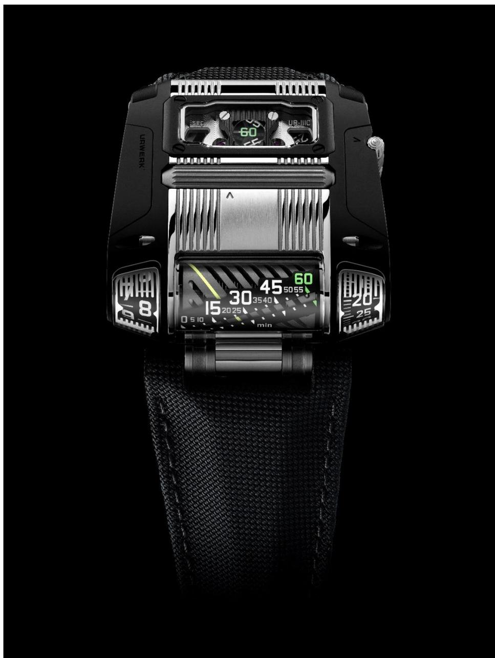
UR-111C TT 包含三项革新制表概念：第一项是取材自汽车仪表盘时钟的回拨直线分钟显示，是继承 UR-CC1 腕表的技术，但又不乏升级新意 -- 分钟刻度呈 30 度斜线排列，显示更加清楚；底下的滚筒转动时，颜色标记线沿刻度推进显示分钟，期间一条弹簧会不断旋紧，当滚筒转动了 300 度，标记已移至 60 分钟位置，这时候弹簧松开，滚筒会再转 60 度，标记像回拨一样返回起点(0 分钟)，同时驱动左边的小时显示跳 1 小时，滚筒转动及数字推进协调丝毫不差天衣无缝，视觉效果令人激赏。
