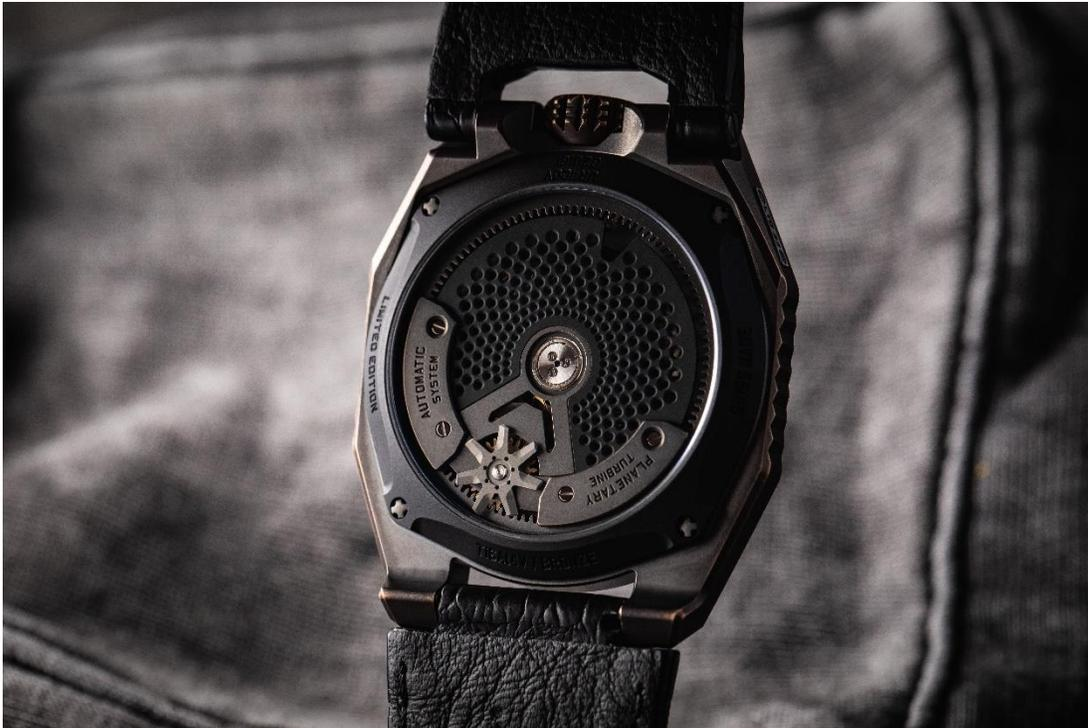
Их круговые равномерные орбиты создают танец юрского периода в уменьшенном масштабе. Подзавод калибра обеспечивает инерционный груз, сопряженный с характерным для UR-100 регулятором Windfänger. Эта планетарная зубчатая передача ограничивает скорость вращения ротора во избежание чрезмерного подзавода и преждевременного износа деталей.
