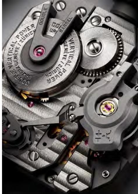
時計の洗練されたムーブメントについて掘り下げる前に注目してもらいたい2つのポイントがあります。ひとつは上部にあるタイミング精度調整ネジ、二つ目はクラウン歯車を効率良く押し出すつまみの間の底にあるプッシャーになります。時計の裏側を見てみると、カバーに覆われたぜん輪の中心部にはバランス振動の正確な速度を測る光学部品が搭載されており、右側のグリルを通して見える電子機器につながる小さなケーブルも確認できます。また、垂直に積み重ねられた二重ゼンマイ香箱が電子回路基板の横側においてはっきりと確認できます。
