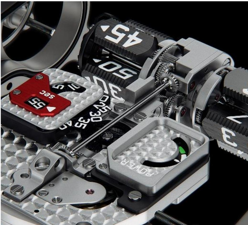
獵錶式錶殼裝配鈦金屬保護蓋，錶殼兩側各有一按鍵，只要按其中一個按鍵就可以打開保護蓋，跳字秒鐘立即展現眼前 – 從放大鏡可觀看到矽質轉碟蝕刻的微細秒鐘數字在除除轉動，旁邊的 48 小時動力儲備顯示是全錶唯一的指針式顯示器。
