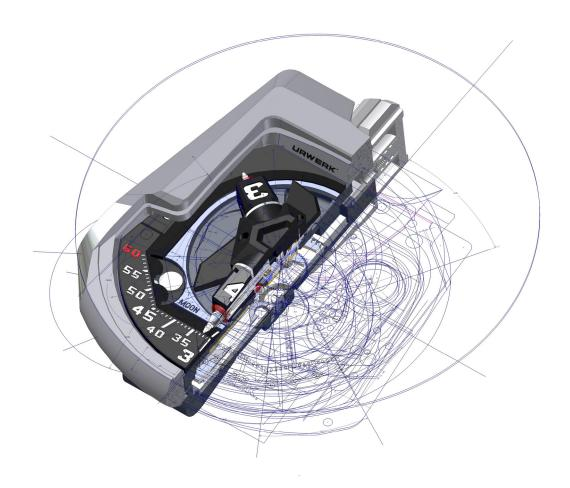
Le carrousel – modèle breveté - forme le centre névralgique de la complication satellite. Il est à la base de la rotation des plots des heures mais aussi de toutes les manœuvres effectuées par les trois aiguilles télescopiques. Le carrousel est d'une technicité telle qu'il requière un usinage au micron près. Après usinage, le carrousel – plots des heures inclus – est ajusté manuellement.
