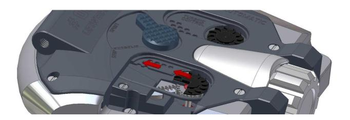
Le système de la « TURBINE AUTOMATIC » se loge dans deux sas hermétiques visibles au dos du boîtier. Ces sas en position fermés ont un volume de 47mm³. Celui-ci se monte à 179mm³ une fois le sas ouvert. Le courant d'air propulsé par la turbine suit alors une trajectoire qui le mène de la surface à une chambre interne à travers un jeu d'« opercules ».
