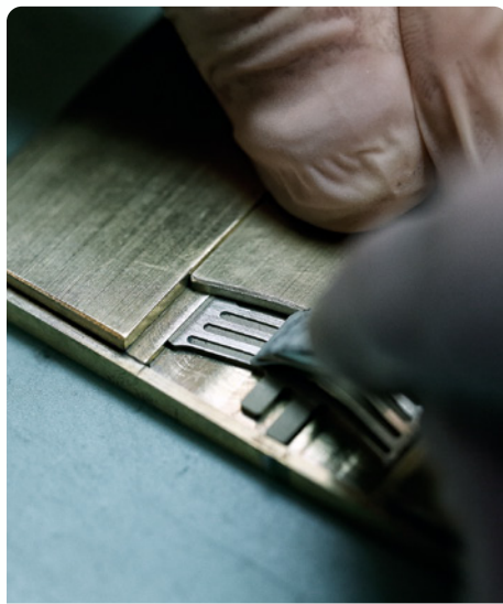
セレクタースイッチがタービンより放出する空気の量を制御します。
